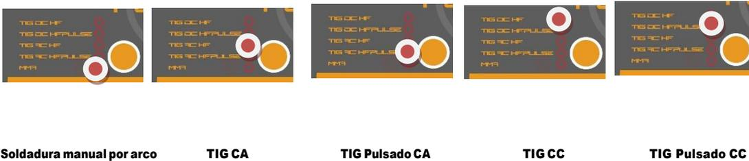
**Fig. 8-9 Selección modos de soldadura**
