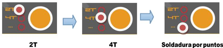
**Fig. 8-10 Selección modos de soldadura 1**
