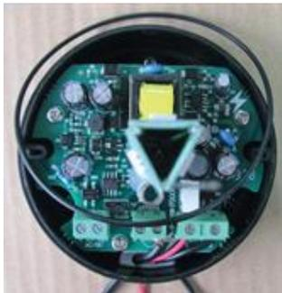
10. Asegure la base con la cubierta con tornillos  $\varnothing 2.3 \times 8$
