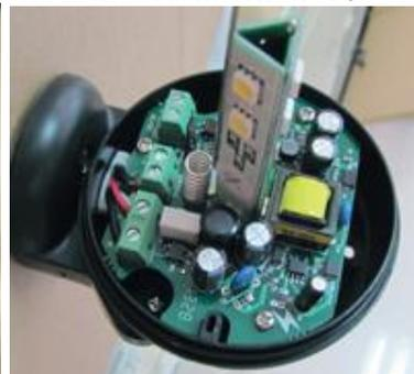
9. Instale el anillo de sello y la cubierta de la lámpara, fije la cubierta de la lámpara y el zócalo de la lámpara con el tornillo de  $\varnothing 2.3 \times 8$  mm
